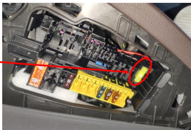
接正极：拆下主驾驶位内饰板找到保险盒位置，使用取电器连接红圈位置
