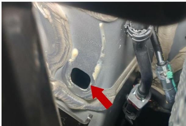
左右踏板电机线穿线：穿线后需用防水胶密封（左右两边踏板电机穿线孔对称）；
