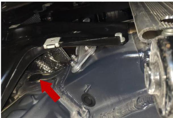
左踏板电机穿线孔：如箭头为底盘穿线孔位置（左右两边踏板电机穿线孔对称）；
