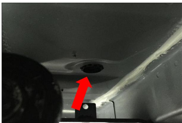
踏板电机穿线孔：把车底电机线从此处车底对应孔位穿进车内，布好电机线后需打上密封胶。外露的线用扎带固定好；
