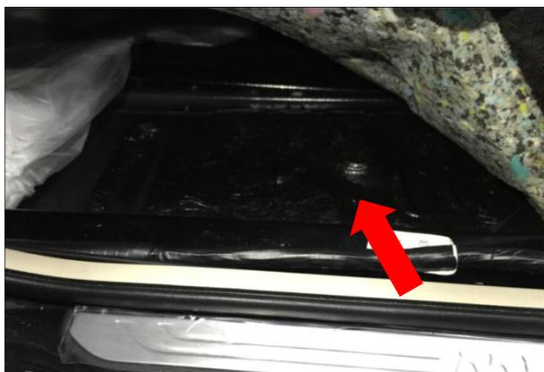
踏板电机穿线孔：掀开驾驶位脚下的海绵垫，看到此处的胶塞孔，用尖锐的工具穿过此处孔，或者钻孔，孔位直径6mm-8mm，左右两边位置对称；
