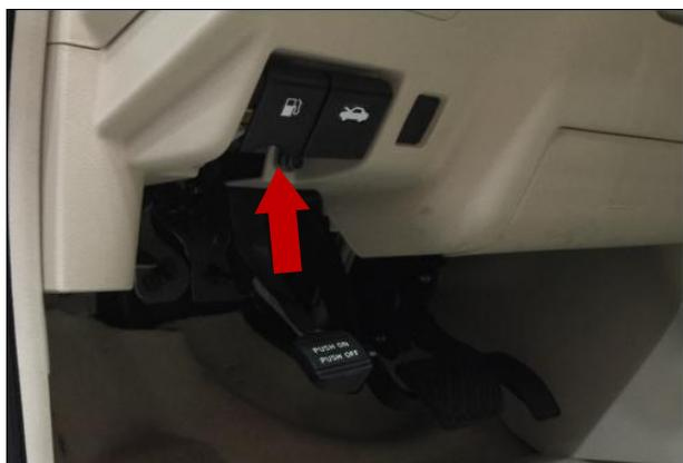
安装开关：首先把此处控制按钮的螺钉拆下，
