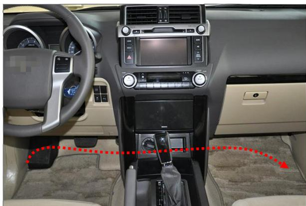
右踏板电机布线：把电机线通过脚下海绵，穿过副驾驶位。（虚线）
