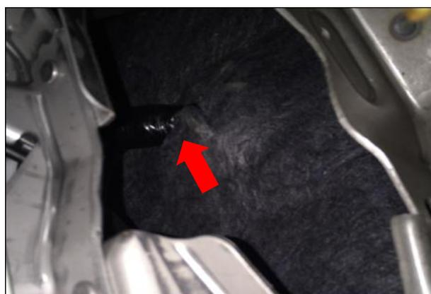
正极布线：利用比较尖锐的工具把线缠上，穿过塑料胶塞，把正极线引至车头
