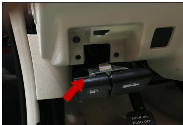
安装开关：然后拆卸原车引擎盖开关按钮；
