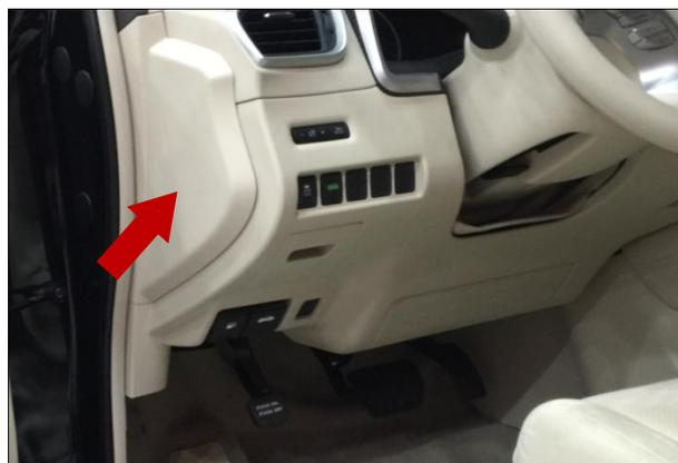
安装 ECU：把所有线束连接及布线完成后，把连接 ECU 的线接上，最后把 ECU 隐藏在中控台内部空旷处，并固定好
