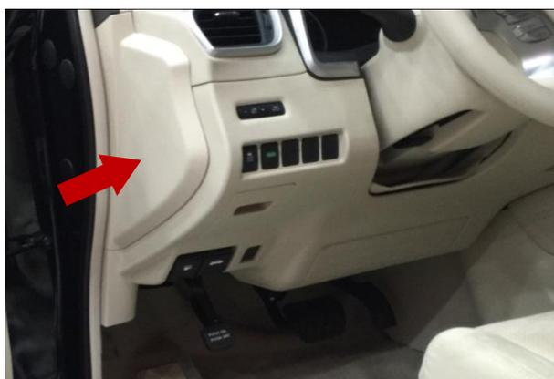
接负极：拆下驾驶位左边此处的中控台装饰件，把黑色负极线搭在内侧不带油漆的螺栓柱上（箭头）
