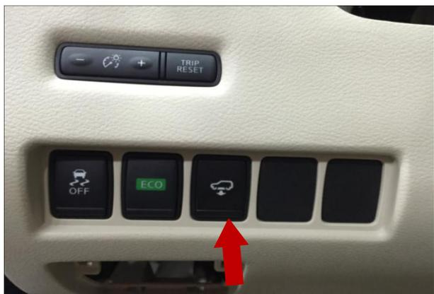
安装开关：把原车塑料件拆下开关按钮安装在此处位置（箭头）
