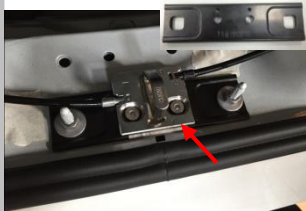
1.3 把我司垫板上, 根据箭头朝向正确安装, 用原车螺母把垫板平行拧紧
