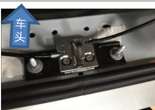
1.4 安装门锁组, 用两颗内六角沉头螺栓配合门锁专用垫圈拧紧螺丝; 注意: 安装时根据开关门的缝隙上下移动锁扣调整至合适位置
