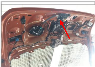
3.10 接门锁信号线：拆下原车尾门上门盖板后，看到原车门锁连接器
