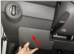
3.13 接正极线：在驾驶室中控台拆下面板，
