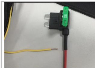
3.16 接解码器正极：把我司解码器线束中的正极（黄色线），如图示意连接到取电器内；
