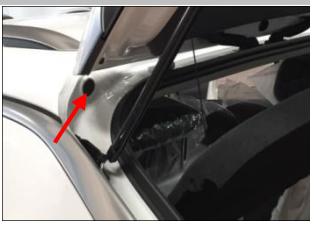
2.7 左电机穿线孔：拆下原车盖板后，看到此原车孔，用于穿电机线，把胶塞装上，防止进水
