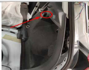
3.22 接负极：在右侧装饰板内找到原车有搭线的负极连接螺栓柱，把我们的负极线搭上
