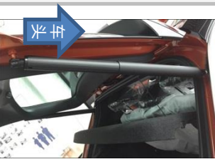
2.6 把我司撑杆如图示意卡进原车固定头内，并确保卡稳，如图右侧已装好，左侧同样安装
