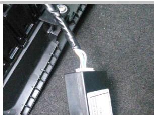
3.25 所有线束接好后把解码器放在主驾驶室 A 柱内侧位置固定好
