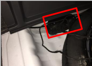
1.9 装有驱动盒的消音盒, 放置在备胎的尾门方向左侧, 需固定好, 防止行车时松动
