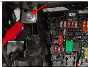
3.24 解码器负极：用解码器负极接此箭头位置连接负极
