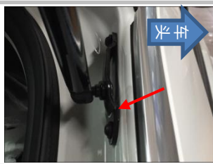
2.2 拆下右侧原车下支架
