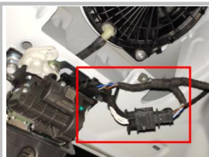
3.12 接门锁信号线：用我们配的转接线连接，再把我司转接线插头（箭头）插进上门锁；注意如图拍摄角度
