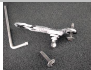
2.3 图为拆下的原车下支架
