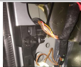
3.28 接解码器信号线：原车线束拆下黑色胶布
