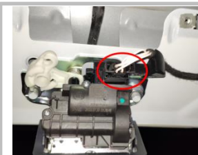
3.11 接门锁信号线：上门锁扣背后如图此位置拆下原车插头连接器，注意如图拍摄角度
