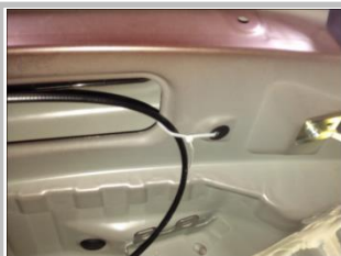
1.10 用扎带把拉线固定好，防止拉线与盖板、钣金摩擦；把我司配的后踏盖安装（图片仅供参考）
