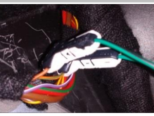
3.30 接解码器信号线：橙棕线为 CAN-L 要和解码器线束中的绿黑线相接，橙绿色线为 CAN-H 要和解码器线束中的绿线相接
