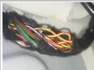
3.29 接解码器信号线：橙绿色接绿黑色 橙棕接绿色
