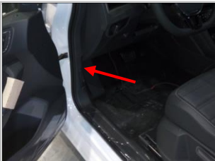
3.26 接解码器信号线：在驾驶室左下角把盖板取下，找到我们要接的线束，（箭头）解码器安装在此处内部固定好防止松动
