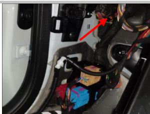
3.27 接解码器信号线：如图角度正视图中正确找到原车黑色线束
