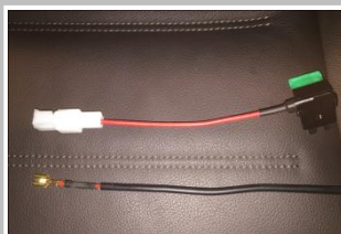
3.14 接正极线：把正极取电器接驳；
