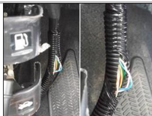
3.11 粉蓝双绞线为 CAN 线，我司所配白线接粉线；黄线接蓝线；
