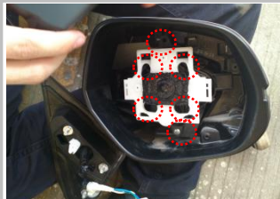
2.8、将固定转向器和外壳的自攻钉取下 (共6颗自攻钉) ;
