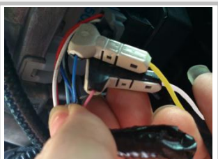
3.12、已经连接好的示意图；(原车的蓝线连接我们的黄线，原车的粉线连接我们的白线)
