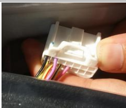
3.2 左侧原车插头： (顶配 XRV，部分配置部分线色无，即插以下存在的线对应位置)第一排：黑白、紫、空格、空格、空格、空格、空格；第二排：黄白、黄红、黄黑、粉、空格、空格、空格。
