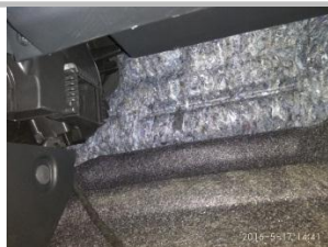
3.4、参考线束连接说明，将 ECU 线束从中控下方右边穿过左边 (配合铁丝使用穿线更方便)；
