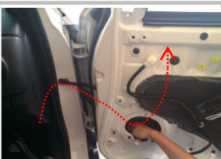
3.6、将 ECU 线束的电机线通过门边波纹管引进门板内 (注意门内线束走向不影响玻璃升降)；
