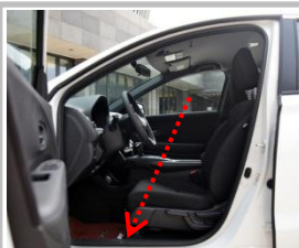
3.5、将门边盖板拆下 (方便将线束从中控穿到门板内)；
