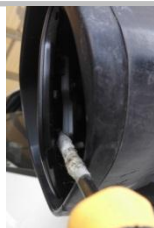
2.2、使用一字螺丝刀分离镜片背面卡扣后将镜片取下（图片为侧面）；
