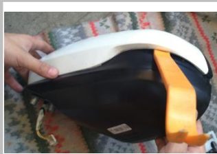
2.9、用翘板将图中外壳取下 (内部为卡扣设计) ;
