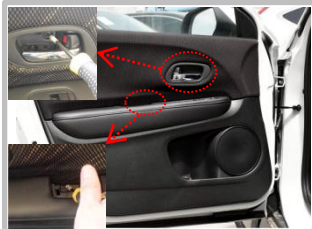
1.1、将原车门板拆下（3 颗自攻钉+周围卡扣）；
