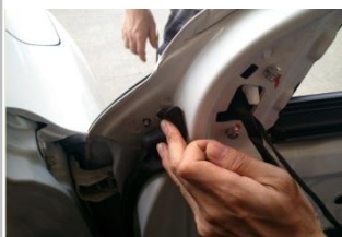
3.1 后视镜组装好后装上原车，用原车螺母固定；
