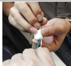
2.6、将后视镜插头与线束拆散开 (使用退针器或者大头针, 建议拆卸之前先拍照纪录线束位置) ;
