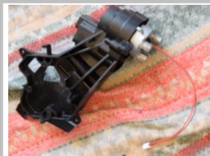
2.12、将我司带有电机的骨架与原车后视镜外壳及底座装配好 (穿线方式参考原车) ;
