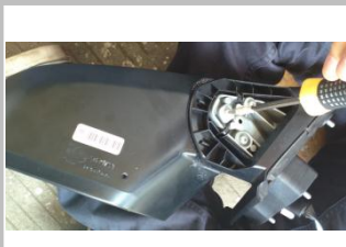
2.5、拆分底座与旋转部分 (底部三颗螺钉) ;
