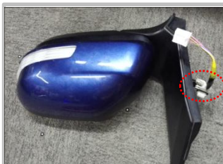
2.6、取下原车后视镜,把圆圈位置线束固定扣拆下,后续还要还原；
