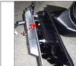
2.19、线束穿过原车软胶，内部的螺钉还原安装；
