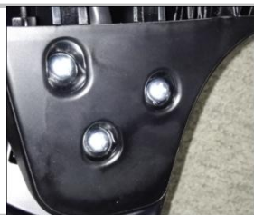
2.18、底部螺钉还原安装，线束固定扣还原安装；
