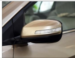
3.13、对照功能说明书检测后视镜功能；把门板、后视镜、中控台还原，中控下方线束用扎带固定好，安装完毕。
