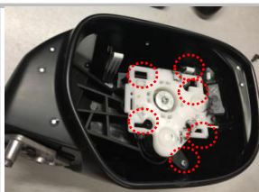
2.17、将固定转向器和外壳的自攻还原安装（共 6 颗自攻钉）；
