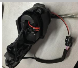
2.13、原车线束、电机线束还原安装；
