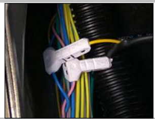
3.9、A 柱连接线如图：粉蓝双绞线，粉色接白色，蓝色接黄色线；高配车也可按照 3.10
