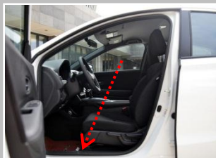
3.4、将门边盖板拆下（方便将线束从中控穿到门板内）；
