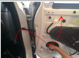
3.5、将 ECU 线束的电机线通过门边波纹管引进门板内（注意门内线束走向不影响玻璃升降）；
