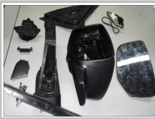
2.5、把原车后视镜拆解成八个部分（八个部分包括线束，不包括螺钉）；
