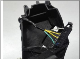
2.8、把线束扣进线槽扣位；
