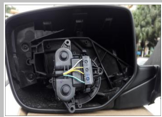
2.9、把我司产品整个嵌入原车后视镜外壳，接上原车镜片调节器，锁螺丝前须检查接线的准确性；
