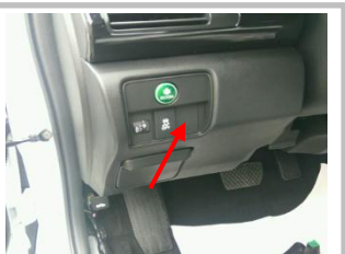
3.9、接开关：将空位拆下出来，我司加装开关安装上去；
