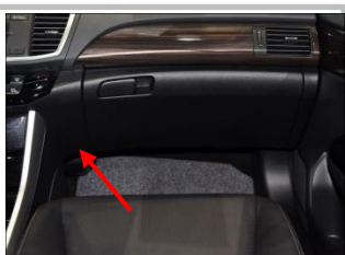
3.3、副驾驶此处位置，线束穿过；提示：ECU 装在副驾驶中控台内侧用扎带固定好防止松动脱落；
