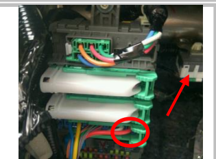
3.6、圆圈位置红色线为正极常电，箭头位置找 CAN 信号线；
