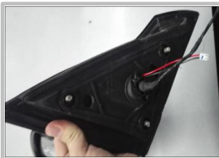
2.16、把我司的底盖插上，再盖上原车泡棉；
