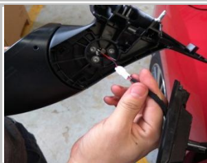
2.19、线束从此孔引出，和左侧电机线对接；
