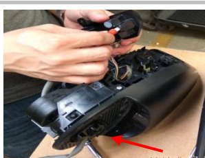
2.14、把原车线束插头插进转向灯上，线束从箭头处穿过；
