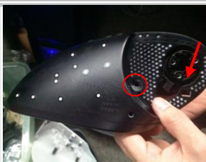
2.12、把底座还原上去，用自攻螺钉 ST4.2*16 螺丝固定，线束从箭头处穿过；
