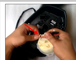
2.15、线束卡在转向灯头此处位置固定；
