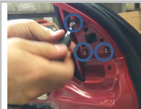
3.1、后视镜组装好后装上原车，用原车螺丝固定；
