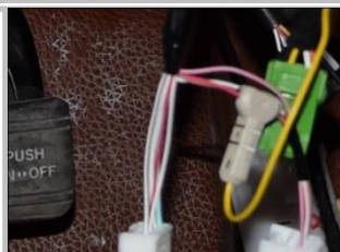
3.11、如背光源线束颜色不同按一下方法查找在汽车点火状态下用试电笔一端塔铁另一端逐个试原车中控开关线再不断的开启大灯试电笔亮则是背光源线束。
