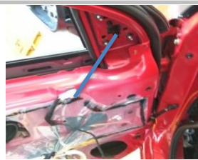
3.3、原车线束接好后和原车插座对接。
