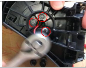
2.18、装上原车底座总成，用工具把螺丝上紧；
