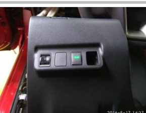
3.6、将左边的中控台位置和开关按钮拆下；
