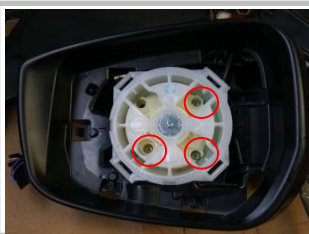
2.4、用工具将三颗螺丝拆下，取出镜片转角器；
