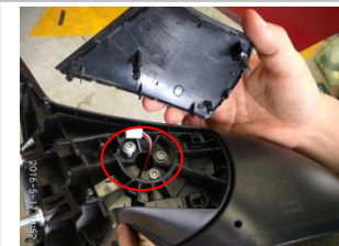
2.7、用工具拆下这三颗螺丝，取下旋转总成；
