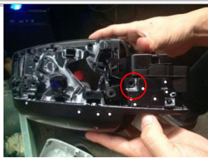
2.11、把底先将旋转总成对应此孔的螺钉卸下，把底座还原上去后，再打上此螺钉；
