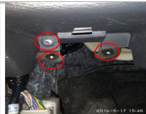
3.5、把这三颗螺丝拆下就可以将中控台面板和发动机盖开关拆下；
