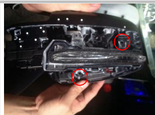
2.13、再把转向灯装在后视镜框上，用两颗螺钉固定；
