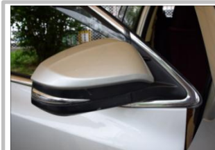
3.16、3.17、把后视镜还原安装时，注意原车与后视镜的间隙完全吻合；
