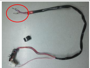
2.8、将原车的接口处剪断，方便取出线束；
