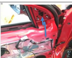
3.8、线束从橡胶处穿过来和后后视镜电机线对接；
