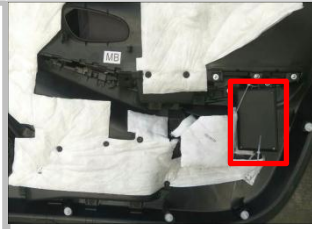
3.14、把 ECU 贴在门板右下角位置（如图），并用扎带固定，再上线束插头，注意线束不能与玻璃升降干涉；
