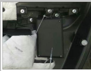
3.15、扎带上面与门板卡扣捆绑，下面与白色海绵捆绑固定；
