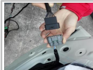
3.13、左门门锁马达转接插头：在左门板位置找到原车插头与我司插头对插转接；
