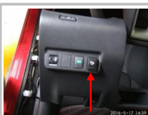
3.9、把我司配的中控按钮安装在此处位置，然后和中控开关对接；
