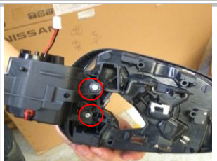
2.10、把我司配的旋转总成装在原车后视镜外壳上，用螺钉固定；
