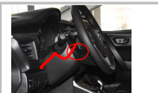
3.7、CAN 线位置：汽油版：直接使用 OBD 转接线对插 OBD， 如 3.8、3.9，无需拆卸方向盘处。
