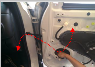
3.2、将 ECU 线束的电机线通过门边波纹管引进门板内（ 注意 门内线束走向不影响玻璃升降）；
