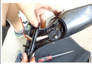
2.18、以拆解的反顺序步骤将后视镜拼回去，还原为一个整体，后壳先不要装；
