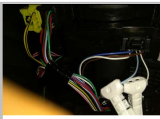
3.15、在方向盘处：白色为 CAN-L，浅蓝色线为 CAN-H；白色线接方向盘处浅蓝 CAN-H 线，黄色线接方向盘处白色 CAN-L 线；
