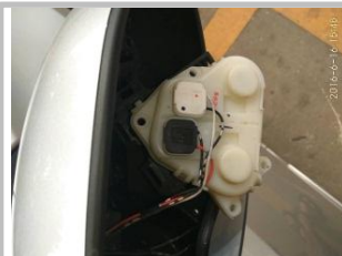
2.11、镜片调节器螺丝拆下后，再把连接调节器的线束拆下；（请注意区分左右）此图片为右；
