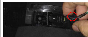
2.14、拔出插头，将转向灯取下拆下原车线束；
