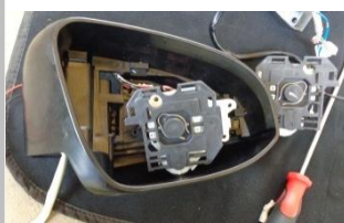
2.10、拔出插头，将镜片调节转头取下；
