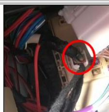
3.18 接正极：此白色粗线为原车正极，接我司红司正极线；
