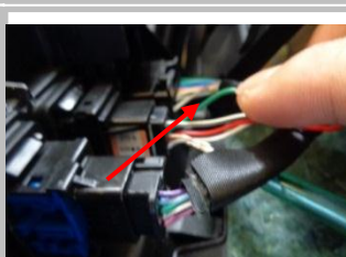
3.6、此处原车两个插头绿色线均为 小灯背光源线 ；将开关插头引出线使用线夹接好此线；
