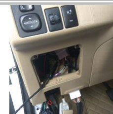
3.17 接正极：正极连接于此处内部；
