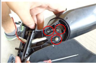
2.8、拆下此处的 3 颗螺钉，卸下支架；
