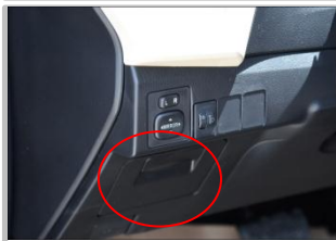
3.16 接正极：拆下中控台盖板；
