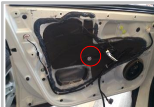
3.19、安装 ECU：线束从车内空隙穿过，注意勿与升级玻璃干涉；可参考线束图，ECU 安装在左门板圆圈大概位置；
