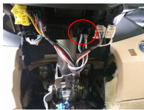
3.14、信号线位置在方向盘下方；
