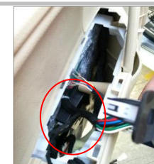
3.21、安装 ECU：如图左盖板复原后 ECU 安装位置；
