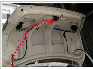
3.3 把 2 扎布线束 (接开关、接门锁信号) 延伸到尾箱上门锁扣处, 延伸线用胶布或扎带固定好; (虚线)
