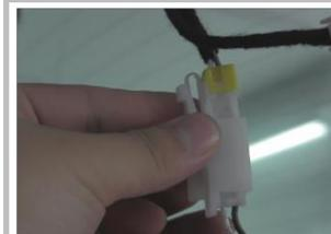
3.4 接撑杆插头端子: 对应颜色线插进凹槽内, 白色对应插槽白色, 棕色对应棕色, 把上面的黄色小卡块摘下移到下面卡紧;
