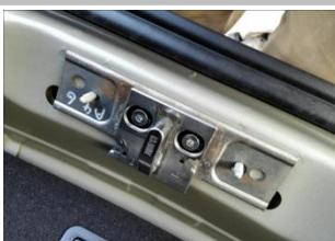
1.7 安装下门锁:把锁扣组装上并用套筒把螺母、弹簧垫圈、大垫圈锁上,用套筒拧紧螺母;
