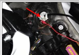
3.11 接负极: 在左侧装饰板内找到螺丝, 把我们的负极线搭上, 松动螺母不用拆下, 卡紧后再还原拧紧螺母;
