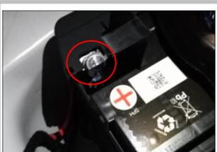
3.10 接正极电源: 用我们的正极电源线连接此处电瓶正极“+”(箭头), 松动螺母不用拆下, 卡紧后再还原拧紧螺母; 提示: 建议最后连正极取电;
