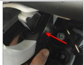
2.6 用夹紧支架与支架总成固定在原车摇臂上，用 4 组标准件螺栓、垫圈、弹垫、螺母拧紧；
