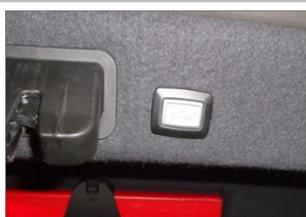
4.4 再把开关底座还原安装回去，用螺钉还原；
