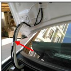
3.2 拆卸塑料扣, 原车摇臂上的塑料件拆下, 把 2 扎布线束 (接开关、接门锁信号、) 从尾箱左侧沿着摇臂延伸到上门锁 (虚线)
