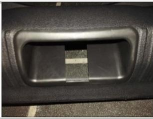
1.13 小后踏盖已装好，最后安装在原车上；
