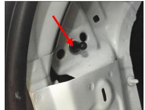
2.3 加一个垫圈与 M8 大垫圈装在万向头上，与内部 M8 通用 T 型螺栓(螺母块)拧紧固定；
