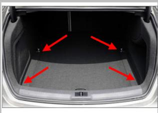
1.2 用螺丝刀把原车 4 处金属件取下,并妥善保管好,后续还原安装;
