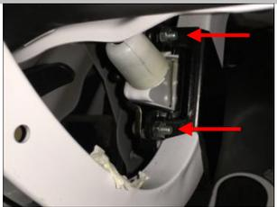
2.7 如图示支架夹在摇臂，注意 4 个螺栓头如图正确朝向，防止螺栓上的螺栓柱刮蹭原车；
