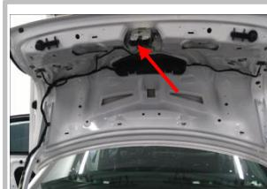
3.7 接信号线 把信号线引到上门锁扣位置, 用与连接原车信号线;
