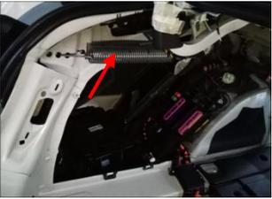
2.1 拆原车拉簧：把原车左边拉簧拆卸；
