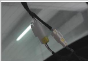
3.6 插头端子连接完成, 轻轻摇晃接头, 确定线束对接稳固;
