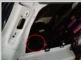
4.2 装 ECU：把 ECU 安放在尾箱备胎底下此空旷处(圆圈)，固定好防止松动；
