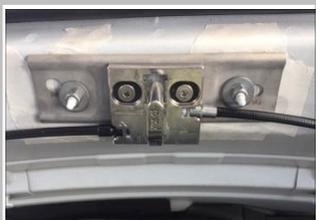
1.8 **注意:**安装时根据开关门的缝隙上下移动锁扣调整至合适位置;
