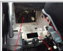
1.10 取出手扶箱盖子、取出里面的海绵。电源线从箱内侧面装入；
