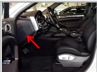
2.1 在驾驶室拆下盖板，看到原车保险盒；
