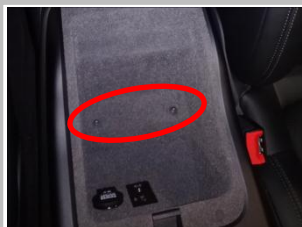
1.7 使用花型螺丝刀拧开这两个螺丝
