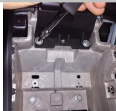
1.9 使用花型螺丝刀拧开此两个螺丝
