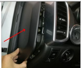
2.2 如图所示拆下原车中控台左侧此盖板；
