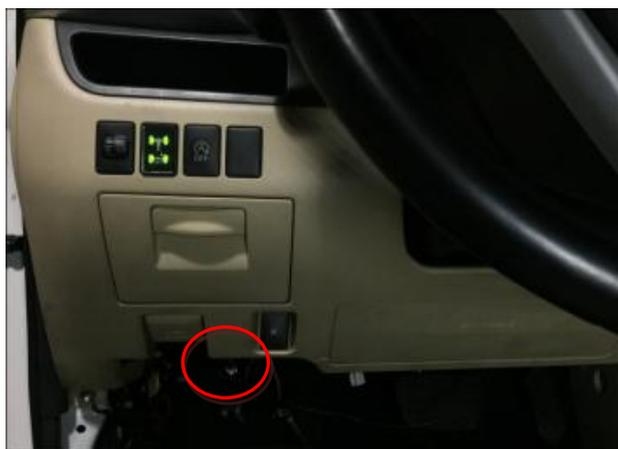
接正极(方式二)：需拆下主驾驶室内侧盖板，正极线束连接于此处位置；
