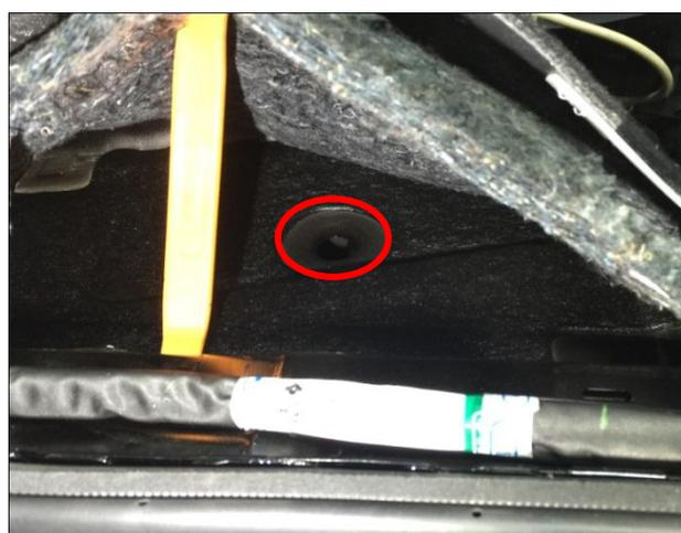
踏板电机穿线孔：看到此处孔位，电机线从此处穿过；(圆圈)
