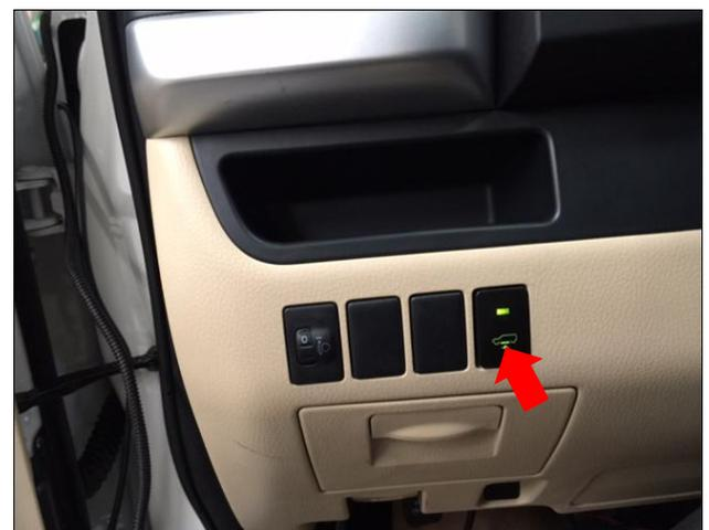
安装开关：把拆下的装饰件还原安装回去即可；（箭头）
