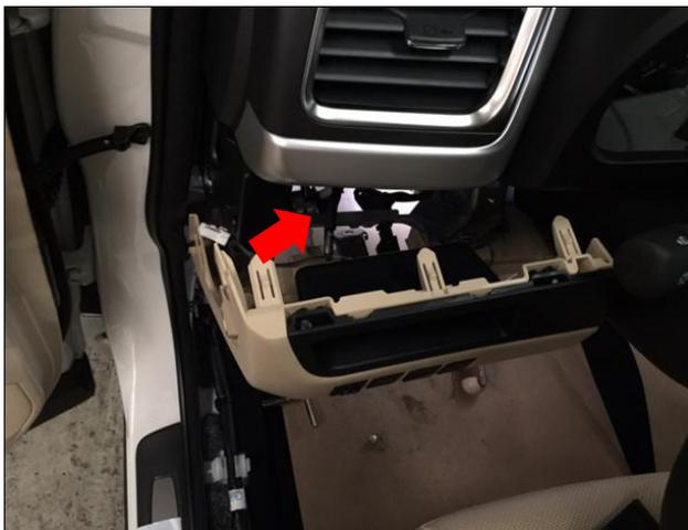
安装开关：拆下之后把我们的开关按钮安装到对应位置，并且把线连接好（箭头）
