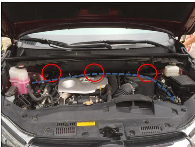
接正极 : 把圆圈处扣拆下, 线隐藏在内部, 再还原卡扣, 正极线 ( 虚线 ) 穿到车头 ;
