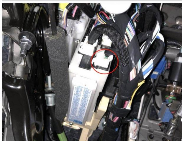
接正极(方式二)：用我司配的正极取电器转接，然后复原安装好
