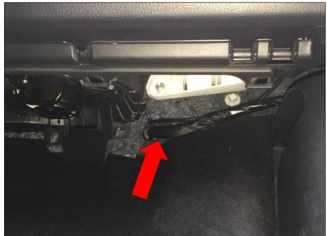
正极布线：拆下装饰板后看到此处穿线孔（箭头）正极线从驾驶室穿进车头；
