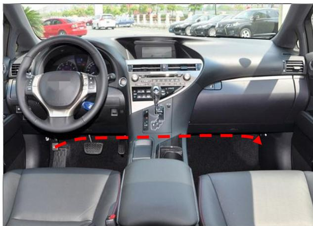
右踏板电机布线：把电机线通过脚下海绵，穿过副驾驶位。(右边电机线较长)
