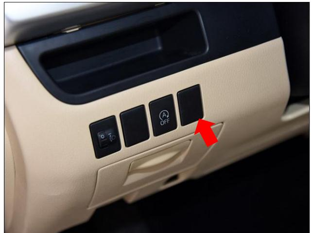
安装开关：首先把原车中控台按钮位置拆下；（箭头）
