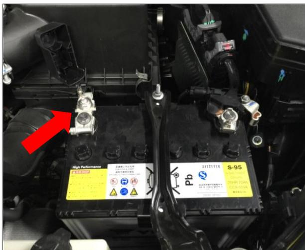
接正极(方式一)：完成以上步骤后，在将我们的红色电源线接入原车电瓶正极，( 箭头 )
