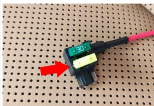
3.13 将从原车取下的保险丝插对取电器上面
