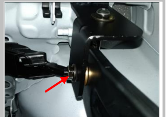
2.21 用工具配合把螺栓拧紧，如图已安装好
