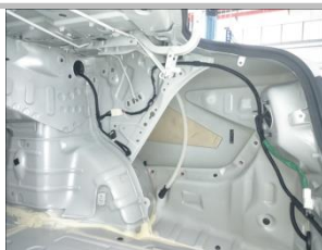
2.2 如图右侧盖板已拆下，
