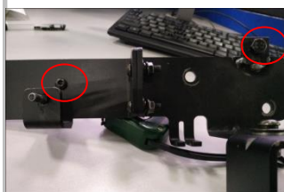
2.7 安装的时候，先把支架上的定位销对准原车钣金孔，然后调整 T 型螺栓位置，从支架孔里伸出来，
