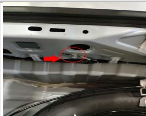
3.19 接尾门负极：原车后踏盖取下后，负极线与此处搭铁螺丝固定。
