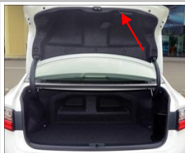
4.1 安装开关按钮：在原车上尾门此位置用于安装开关按钮；
