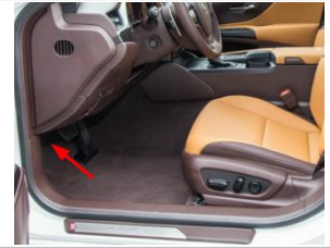
3.9 正极取电位置一：在方向盘下方的保险盒内。（低配车型）
