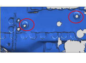
2.8 如图为定位销需要对准的原车钣金孔
