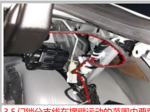
3.5 门锁分支线在摆臂运动的范围内要留有足够的长度, 避免在运动过程中刮伤线束, 须反复做开门/关门测试, 确保不会有干涉、刮擦、拉扯线束的情况发生, 再用扎带把线束固定好!
