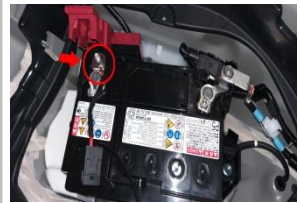
3.18 将组装好的正极线铜叉子与电瓶正极的螺丝固定好。
