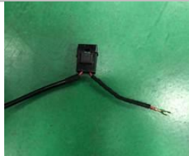
3.17 将正极线端子与附带的保险丝座子如图组装好。
