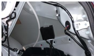
3.24 将 ECU 用魔术贴贴在车身右侧钣金光滑处。
