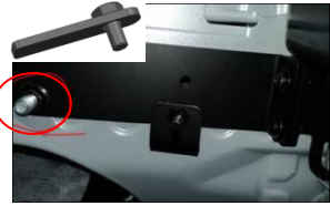
2.14 固定下支架组件三：用 T 型螺栓、六角法兰面螺母 M10 安装在原车上
