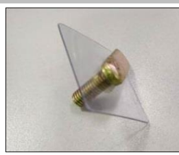
2.6 将 PVC 塑料卡块套入 T 型螺栓，然后将螺栓安装在对应孔内
