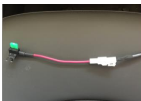
3.14 将正极线的端子与取电器配套的白色插头组装好，并与取电器对插好。
