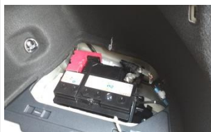
3.16 接正极线（二）：在后备箱右侧的电瓶处。（高配车型）
