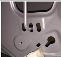
2.4 ES300 安装产品时，无需调整原车扭簧位置；ES200 安装产品时，需要把原车两侧扭簧均向前调整 1 格
