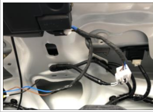
3.8 将门锁转接线插回到原车门锁插头上，原来门锁线也对插好！
