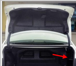
3.2 ECU 安装位置在后备箱右侧饰板内
