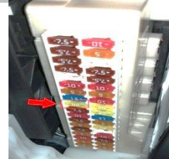
3.12 接正极线（一）：保险盒在底部箭头位置，取 12V 常电的保险丝（20A）注意：安装后保险盒盖子无法安装
