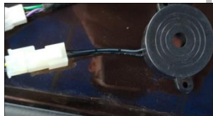
3.22 安装蜂鸣器：把插头对插好，并把蜂鸣器装在装饰板内空旷处；(ECU 附近)
