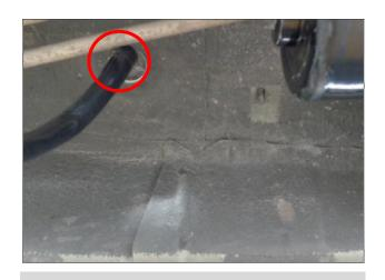
右踏板电机穿线孔:首先把车底胶塞卡进电机 线上,座椅底下对应车底此处孔位,穿线之后 需打上密封胶。外露的线用扎带固定好;
