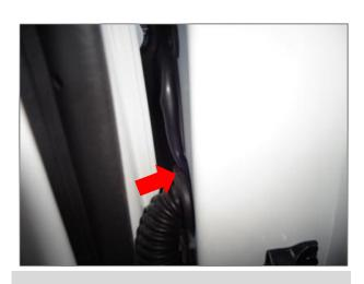
正负极布线:此时线已经穿过波纹管,在原孔周边打防水胶,然后把波纹管还原安装并封紧防止进水。(箭头)
