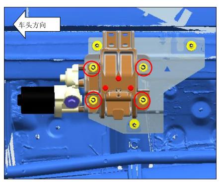
第四步:安装踏板(左右两边安装方法一致)
