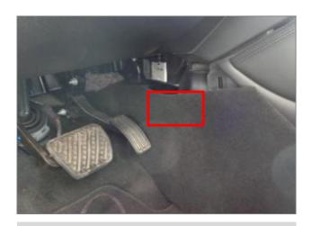
安装 ECU:在驾驶室右侧位置的内部找到大捆的线束,或者位置好的铁支架,利用扎带穿过我们 ECU 的孔,并扎紧固定住;
