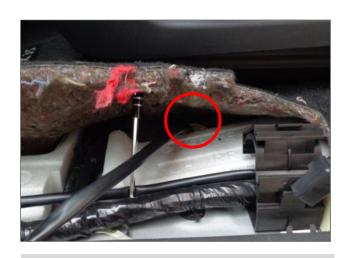
左踏板电机穿线孔:座电机线穿线孔对应位置 (箭头)(左右两边对称位置)
