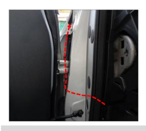
正负极布线:先拆下车门连接处的波纹管,把 正负极线一端头从驾驶室左下角处穿过波纹 管(虚线),把线从内侧(箭头)延伸出车头。
