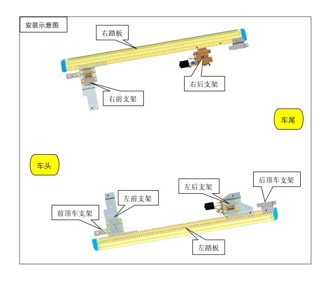
第二步:安装支架:找到车底对应安装孔,把对应支架安装上,以下所有安装螺丝螺栓先不要全部锁紧;
