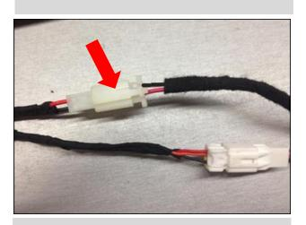
左边电机接线方法:首先把黄色端头盖线束两边端头颜色——对应,然后把另一个端头的电机线正负极反向接驳,既红色线接黑色线,黑色线接红色线(箭头)
