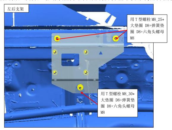
(5)装后顶车支架:拆下原车螺钉,把后顶车支架装在对应位置上,装上对应配件、螺栓及垫圈; 左右两边安装方法一致(安装简图如下)
