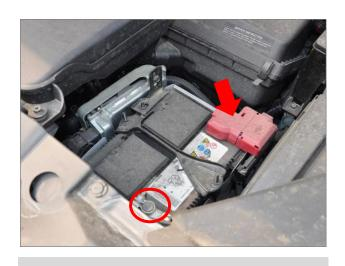
揭开红色盖用我们的红色线接电源正极(箭头), 用我们的黑色线接负极(圆圈);(建议最后连接通电)
