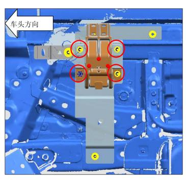
2、安装支架组件三:把支架组件三与左后支架连接,用 D10 平垫片、D10 弹簧垫、M10 螺母锁紧;提示:另一边把支架组件三与右后支架连接,用 D10 平垫片、D10 弹簧垫、M10 螺母锁上,待安装踏板后锁紧;
