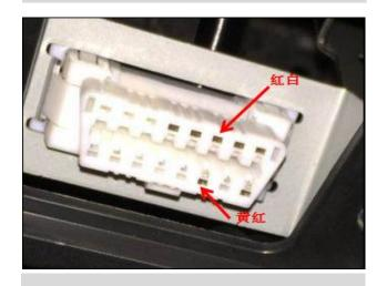
接原车信号线:用我司线束在原车 OBD 对应 位置接线
