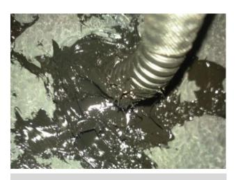
密封穿线孔:穿线后,左右两边务须使用密封 胶涂在穿线孔处,防止底盘进水;(图片仅供 参考)
