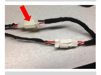
右边电机接线方法:首先把黄色端头盖线束两边端头颜色——对应,然后把另一个端头的电机线红色线接红色线,黑色线接黑色线(箭头)
