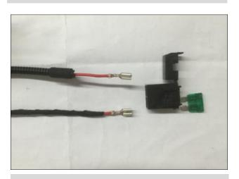
分别将带有金属端子的线插如保险盒内,线插好后轻轻摇晃接头,确定线束插头稳固;确定线束插头稳固,若有松动容易拔出插头调换接头方向再插紧;
