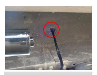
左穿线孔:如图此处孔位为左侧车底穿线孔
