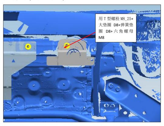
(6)装前顶车支架:拆下原车塑料胶塞,把前顶车支架装在对应位置上,用原车螺丝装上;左右两边安装方法一致(安装简图如下)
