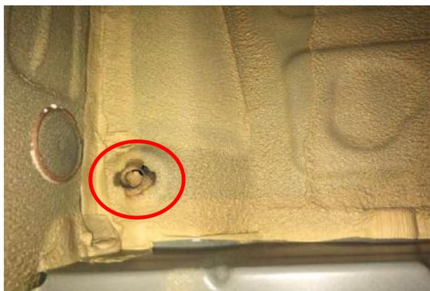
右踏板电机穿线孔：如图为右边底盘穿线孔位置（左右两边穿线孔位置对称）；
