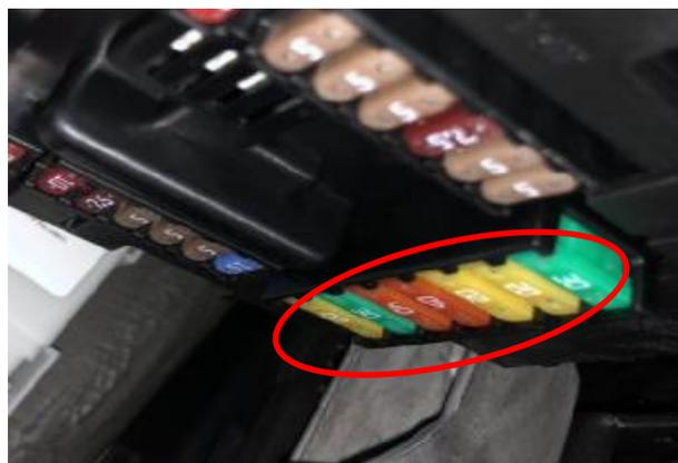
接正极线：把取电器插入原保险盒取电（红圈 30A 保险丝），线接口处固定好，防止松动；**建议最后连正极取电；**
