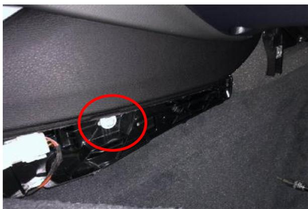
接负极：在副驾内找到不带油漆的螺母或接线柱接负极（红圈位置位于左边电机穿线位置）
