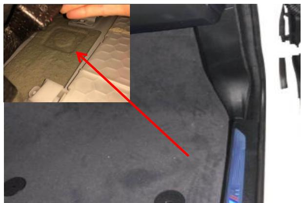
右踏板电机穿线孔：掀开此处垫脚海绵，看到线槽（箭头）
