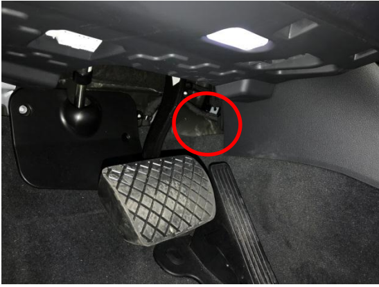
右踏板电机布线：穿过此孔延伸至副驾驶位。
