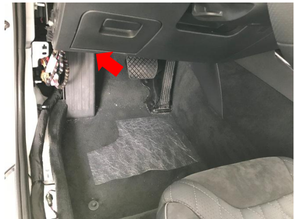
安装 ECU：在主驾驶室位置的内部找到大捆的线束，或者位置好的铁支架，利用扎带穿过我们 ECU 的孔，并扎紧固定住；注意：需固定住 ECU，并且不能使得它外露
