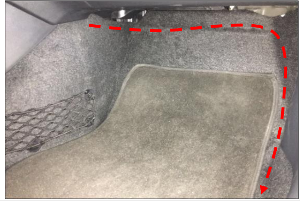
右踏板电机布线：把电机线通过脚下海绵，穿过副驾驶位。（右边踏板电机线较长）
