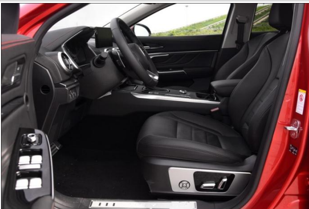
安装内饰件：把迎宾踏板及驾驶室左下角装饰件还原安装。检查所有安装是否全部锁紧，检查踏板的运动功能是否正常，即可完成安装。
