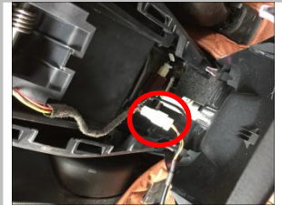
1.14 安装完成后将电源线用扎带跟下面的线绑在一起
