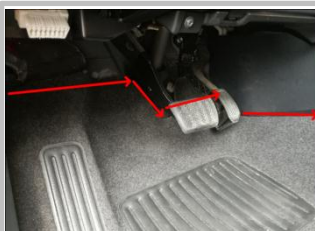
2.1 从主驾接线走脚刹下毛毡至 A 柱中控内饰板；
