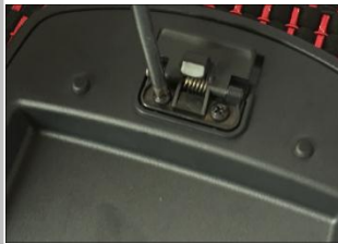
1.8 将原厂手扶箱螺丝及卡扣取出，安装到我们的净化器上
