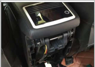
1.13 转轴穿过另一端后将净化器关上，再用开口挡圈将转轴固定好。
