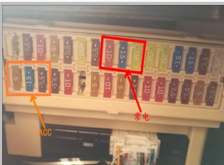
2.7 接 ACC/接正极常电：在驾驶位中控台左侧此位置找到原车保险盒，ACC、正极连接于此内；
