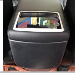
2.12 发动汽车引擎检查净化器有没有正常工作，复原所有连接位螺钉；
