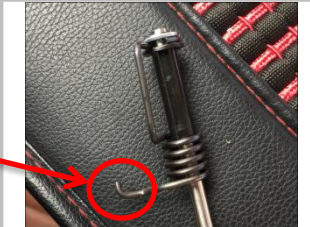
1.11 安装后的状态如图所示，安装弹簧的时候注意要将净化器打开到顶点位置，这样会方便安装
