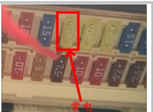
2.9 接正极常电：将我们线束剥线，线缠绕在原车 20A 保险丝上再插入原位即可（认准孔位安装）；
