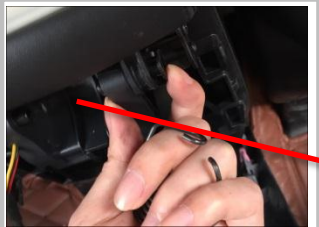
1.10 将原厂黑色塑料件复原安装好，再将弹簧带钩的一段钩住净化器底座筋位上，最后安装转轴
