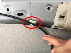
5.9 用扎带把圆圈位置的拉线固定好，防止拉线与盖板、钣金摩擦；
