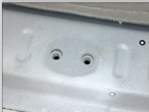
5.2 拆下原车锁扣组；
