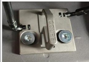
5.3 把我司锁扣组装上，根据箭头朝向正确安装，再把锁扣组装上；
