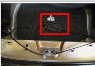
5.8 把包装好的驱动盒安装在如图空旷位置，需固定好，防止行车时松动；
