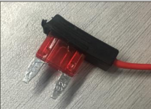
2.8 接 ACC/正极方式一 ：如上图用保险丝取电器时，需把红色接头拔出来
