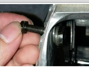
1.12 把螺栓穿过手扶箱，安装标准配件以左侧为例，右侧对称安装
