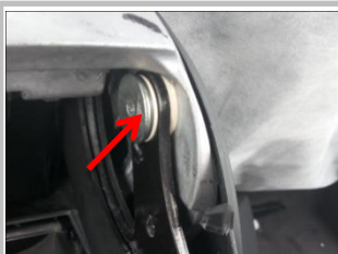
1.4 拆下原车左右对称两颗螺钉
