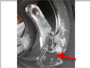
1.8 从原车手扶箱支架上拆下“回位塑料件”
