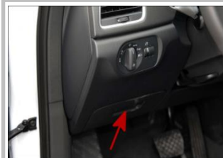
2.7 接 ACC/接正极常电 拆掉驾驶室左下角 A 柱盖板，看到此原车保险盒
