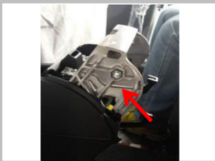
1.7 把原车这块铁片抽出一点，方便拆装手扶箱
