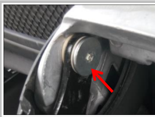
1.5 左边螺丝同样拆下
