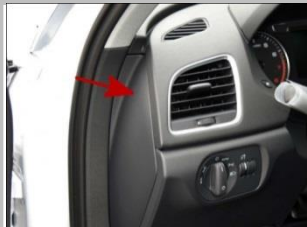
2.5 接负极 ：拆下此主驾驶室中控台左侧盖板（箭头）
