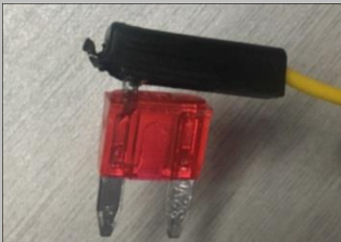
2.9 接 ACC/正极方式一 ：需把插头拔出如图示意箭头位置脱离，预防安装时没有插到位，然后再正确插入保险盒内
