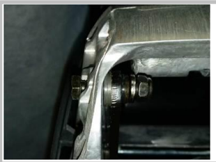
1.13 图为已安装好左侧螺栓标准件
