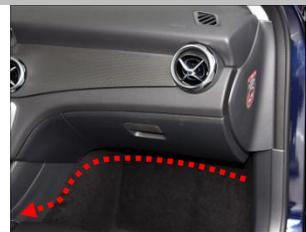
2.1 布线示意:如图虚线走向为电源线布线,需把线束隐藏在地毡下;
