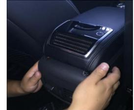
1.9 装上塑料盖,安装时保证与卡扣配合的孔槽没有电源线干涉;
