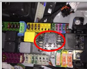
**2.10 接线方式二：**用我司取电器插头直接插入原车图示空脚位置连接正极常电、ACC (如图已安装好)
