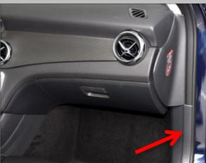
2.2 将图中所示副驾驶室 A 柱侧面塑料盖板拆下,保险盒在内部;
