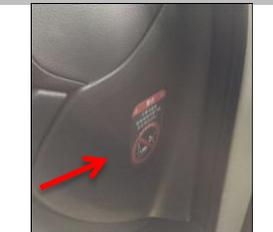
2.3 拆下右侧中控台此面板;负极在内部;
