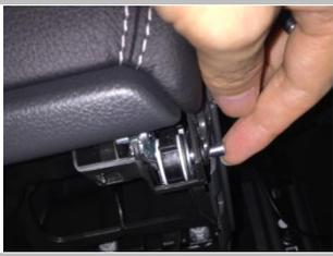
1.4 用工具将两边的轴销取出,不要丢掉,后续需复原安装
