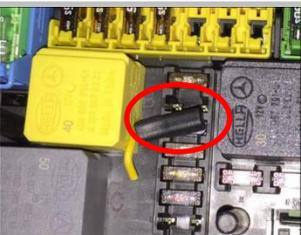
**2.12 接 ACC：**把我司 ACC 取电器插入图示的空脚内，如图已安装好，(认准孔位安装)
