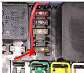
**2.8 接正极常电** 拆下原车此位置保险丝，缠上还我司红色正极，再复原保险丝（认准孔位安装）
