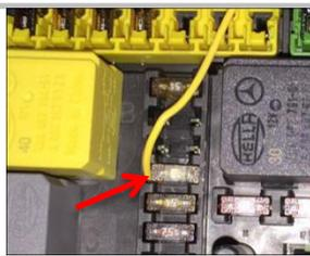
**2.9 接 ACC：**拆下原车 5A 保险丝，缠上还我司黄色 ACC，再复原保险丝（认准孔位安装）
