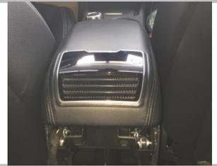
1.6 取出原车手扶箱,安装净化器,再将轴销与螺钉装好
