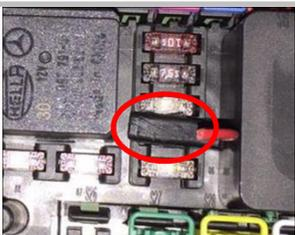
**2.11 接正极常电：**把我司正极取电器插入图示的空脚内，如图已安装好，(认准孔位安装)
