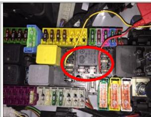
**2.7 接线方式一：**分别把接正极常电、ACC 电源取电器剪掉；(如图已安装好)
