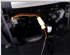
**2.14 所有布线接线完成后，最后插上插头；**
