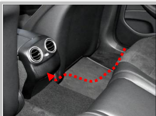
2.6 布线： 线束穿出右侧后排座椅在经过地毡如图示意，延伸到手扶箱；
