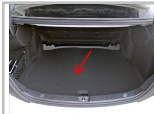
2.1 布线： 拆下原车尾箱盖板；
