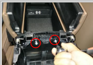
1.6 内侧 2 颗螺钉需拆下
