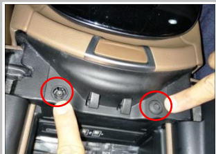
1.7 在中控台位置 将 2 个胶粒撬开后，把下面 2 颗螺钉拆下
