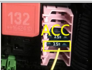
2.18 接 ACC： 将我司取电器上保护帽剪掉，取下原车 15A 保险丝用我司 ACC 铜线缠上再还原插入保险丝位置；
