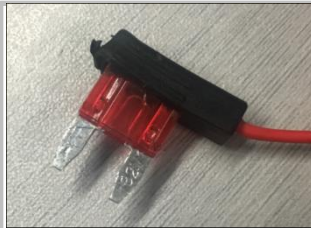
2.14 接正极： 如上图用保险丝取电器时，需把红色接头拔出来；
