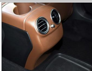
2.19 空调后排排出风扣入正确位置，复原；
