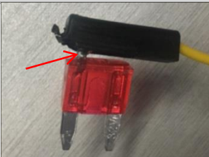
2.15 接正极： 需把插头拔出如图示意箭头位置脱离，预防安装时没有插到位，然后再正确插入保险盒内；
