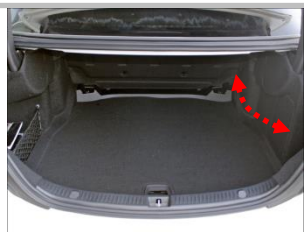
2.3 布线： 如图示意，线束从尾箱右侧虚线示意走向，到右侧后排座椅底下；
