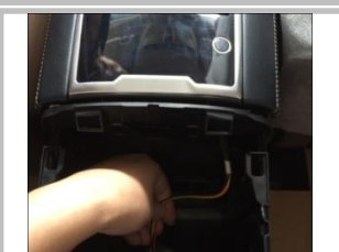
1.26 安装产品，用扎带锁紧电源线，预留足够活动空间，注意：验证电源线不会被磨损，防止干涉线束；
