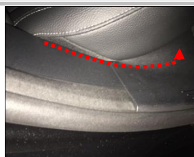
2.5 布线： 线束穿出，露出来的线束塞到皮套内部隐藏；
