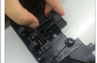
1.15 中控台锁扣位置需拆下原车塑料件、弹簧，此步骤需反向安装在我司产品上
