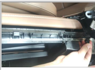
1.12 把原厂手扶箱上的灯条拆下
