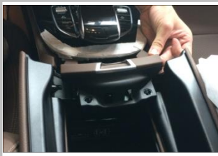
1.8 掀开中控台位置盖板不用拆下，方便拆卸底下螺钉即可
