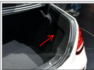
2.2 布线： 拆下尾箱右侧盖板、正极、负极、ACC 接于内侧；
