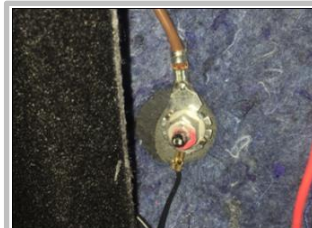
2.13 接负极： 负极在尾箱右侧位置看到原车螺栓柱，装上负极连接片拧紧；
