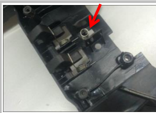
1.16 原车锁扣件拆下后，拆下原车此弹簧
