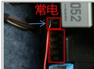
2.16 安装方式一接正极常电 将我司取电器上保护帽剪掉，取下原车 7.5A 保险丝用我司正极保险铜线缠上再还原插入保险丝位置；(箭头)
