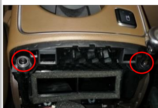
1.4 拆下左右 2 颗螺钉，妥善保管，后续还原安装
