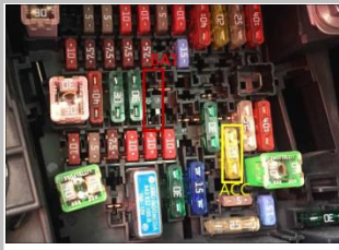
2.8 如图示意，原车 ACC、正极安装位置
