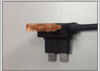
2.9 把原车对应位置保险丝取下，插在我司对应取电器上后，再把我司取电器插头复原
