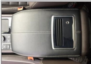
1.13 把原车后排空调出风口盖子复原安装，如图为我司净化器已安装好
