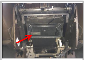
1.12 将出风口上的塑料件安装好，并将电源线固定在里面，前一步骤预留的线束足够安装此塑料件
