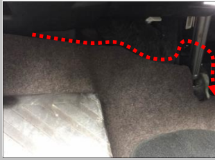
2.2 通过脚刹下面(虚线示)及座椅边缘缝隙隐藏, 注意线束切勿干涉
