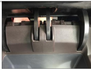
1.10 将净化器打开，从前面观看四条旋转筋与车身的槽间隙是否均匀，如不均匀，可左右微调至均匀处，再将螺丝锁紧固定
