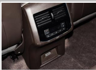
3.2 空调后排排出风扣入正确位置，复原
