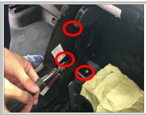
1.6 拆下此处原车 3 颗螺丝 左右两边对插位置
