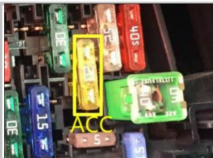
2.10 接 ACC 方式：取出此原车保险丝插在我司取电器上，再复原安装在原 ACC 位置，确保孔位正确
