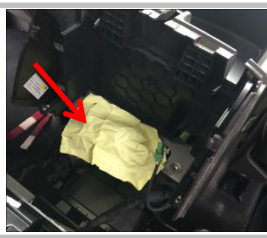
1.5 将出风口用东西盖住，防止在拆卸过程中有螺丝掉进去不好取出
