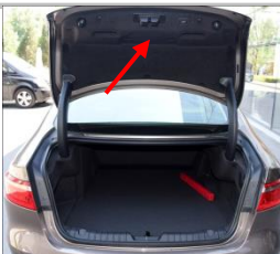
3.1 拆卸上门锁盖板，然后把线束如虚线穿到上门锁盖板；
