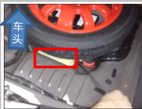
2.8 把包装好的驱动盒安装在如图空旷位置，需固定好，防止行车时松动
