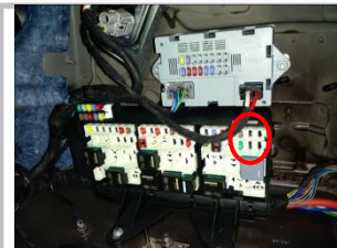
3.11 接正极： 在尾箱右侧如图位置找到原车保险丝正极
