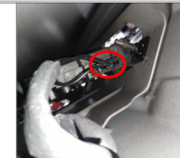
3.5 接门锁信号线：如图角度找到此原车接头
