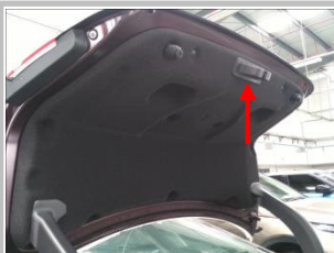
3.4 接门锁信号线：在上尾门找到原车信号线位置
