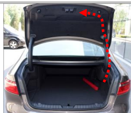
3.3 把2扎布线束（接开关、接门锁信号）延伸到尾箱上门锁扣处，延伸线用胶布或扎带固定好；（虚线）
