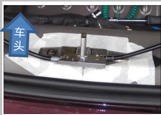
2.4 安装下门锁扣：把门锁装上，用2颗异型螺栓平行拧紧，注意：安装时根据开关门的缝隙上下移动锁扣调整至合适位置
