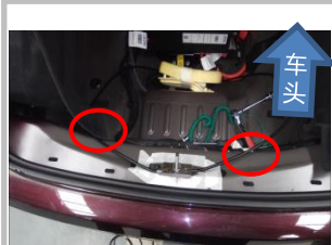
2.9 用扎带把圆圈位置的左右两边拉线固定好，防止拉线与盖板、钣金摩擦
