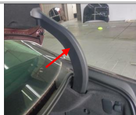
3.2 拆卸塑料扣，原车摇臂上的塑料件拆下，把2扎布线束（接开关、接门锁信号、）从尾箱右侧沿着摇臂延伸到上门锁
