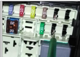
3.12 接正极： 将保险丝取电器脚码芯片插入保险盒脚码芯片凹槽内取电；注意：如图对应位置正极插入，若反插将导致尾门无法使用
