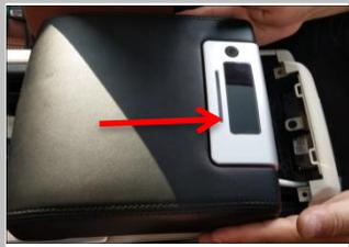
1.9 把我司净化器往后推进(箭头示意),让固定定位吻合；
