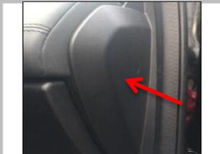
2.9 负极: 拆下右侧中控台此盖板;
