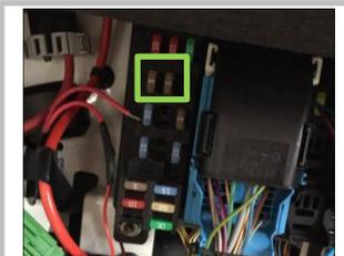
2.15 当剪掉取电器, 剥线安装时, 需取下原车保险丝, 建议正极\ACC 都分别接原车 5A 保险丝即可;
