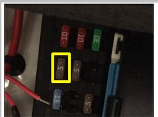
2.17 接 ACC: 拆下原车 5A 保险丝, 缠上还我黄色 ACC, 再复原保险丝(认准孔位安装)
