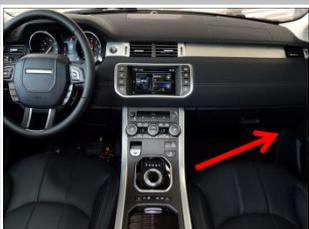
2.1 拆下副驾驶位右侧下角内部位置装饰件,线束连接在此处；
