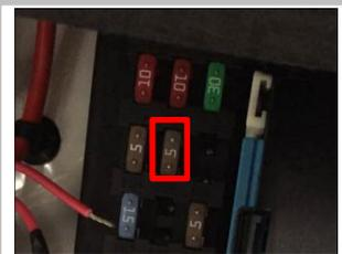
2.16 接正极常电 拆下原车 5A 保险丝, 缠上还我红色正极, 再复原保险丝(认准孔位安装)
