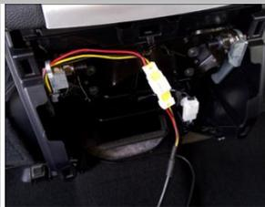
2.20 所有布线接线完成后，最后插上插头，线束用扎带固定好勿干涉；
