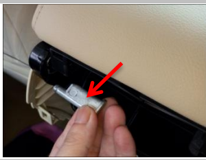
1.4 如图所示箭头处连接轴需拆下，
