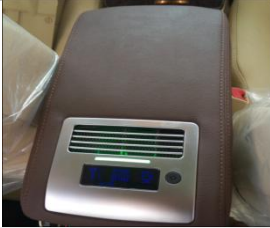
2.1 安装净化器：握住手扶箱钣金，将整个空气净化器往前推回到原位位置；
