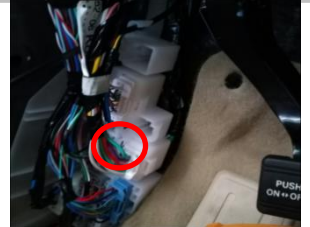
2.6 连接 ACC：在驾驶室 A 柱左下角看到此圆圈原车正极接口大概位置，认准孔位安装。
