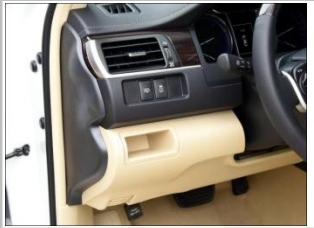
2.3 将图中所示侧面塑料盖板拆下；
