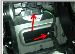
1.10 暂时拔下原车插头、线位卡扣
