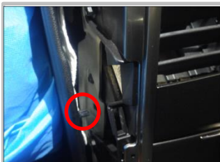
1.4 小心松开此处原车卡扣, 掰开塑料件看到内部螺栓
