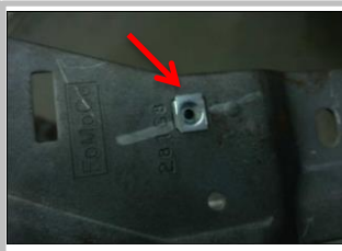
1.12 把原车支架上 4 个金属扣拆下
