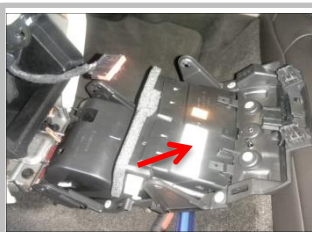
1.6 如图示意, 拆下出风口
