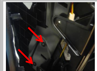
1.15 用拆卸的顺序反向安装回去, 复原整体, 各部位螺钉平行拧紧, 线束插头复原安装
