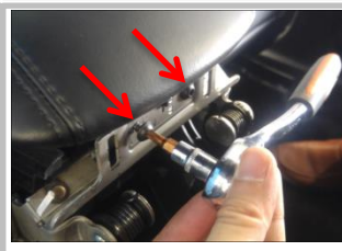
1.9 在拆卸此两颗螺钉
