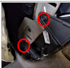
1.5 拆下此位置左右各两颗螺钉, 后续拆下螺钉需全部妥善保管, 需复原安装
