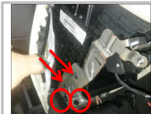
1.7 拆下此位置左右各 4 颗螺钉, 后续拆下螺钉需全部妥善保管, 需复原安装
