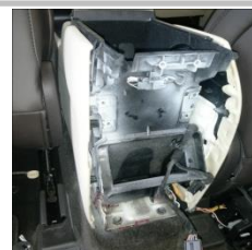
1.11 如图, 原车手扶箱拆下
