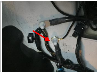
3.6 接负极：在右侧装饰板内找到螺丝，把我们的负极线搭上，负极线铜片卡紧后再还原拧紧螺母
