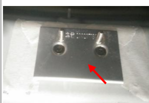
1.3 把我司垫板组装上，根据箭头朝向正确安装，再把锁扣组装上；
