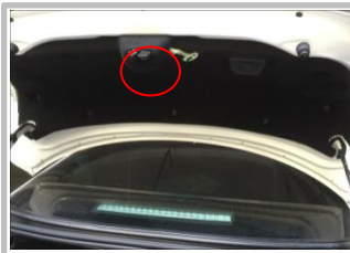
3.7 接门锁线：在尾门上方，圆圈位置找到原车信号线插头；注意如图拍摄角度；
