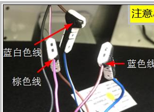
3.9 接门锁线：分别用我司两根线既（蓝色线、蓝白色线）接剪断的原车紫棕色线，如图箭头示意；
