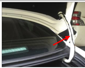
3.2 拆卸塑料扣，原车摇臂上的塑料件拆下；
