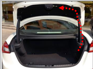
3.3 信号线、功能开关线布置到上门锁，如需线示意；
