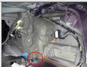
3.5 接负极：在尾箱右处找到线束（圆圈），然后找到我们要接的信号线，
