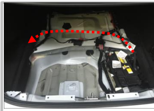
3.4 左撑杆电机线如图虚线示意走向；
