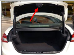
3.1 拆卸上门锁盖板，
