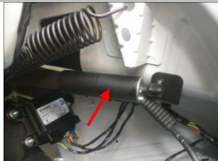
2.11 安装撑杆：把撑杆总成两头分别卡进万向头，轻轻按压让其卡进即可； 用同样方法对称安装另一边撑杆
