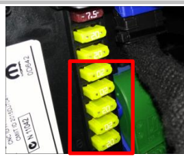
2.11 接正极 ：此方框内均为正极，取其一连接我司正极线即可；
