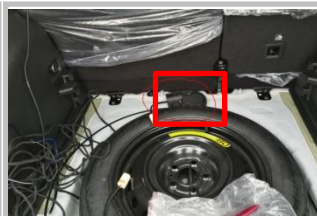
3.8 把包装好的驱动盒安装如图尾门空旷处，需固定好，防止行车时松动；
