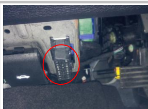
2.20 解码器 OBD ：拆下原车 OBD 插头，用我们的接头还原安装，露出来的线隐藏好；
