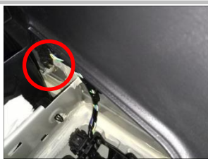
2.12 接负极 ：负极接线位置线束负极接线位置在尾箱左侧看到不带油漆的螺栓柱，装上连接片拧紧；
