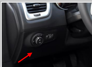
2.10 接正极 ：拆下中控台，箭头处面板，看到原车保险盒；
