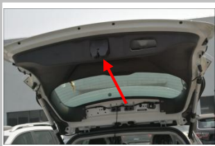
2.13 接门锁信号线 ：开锁信号线和状态信号线接线位置在门锁附近；
