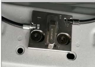
3.4 用两颗螺钉拧紧； 注意 ：安装时根据开关门的缝隙上下移动锁扣调整至合适位置；
