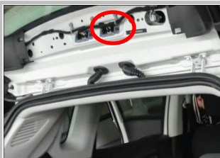
2.16 接解码器控制信号线 ：在尾门上方此位置找到原车控制信号线接头；
