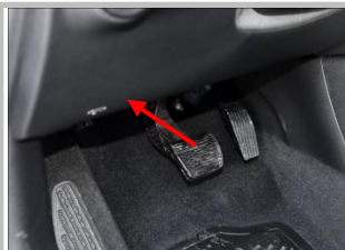
2.19 解码器 OBD ：在驾驶室中控台底下找到 OBD 接口；
