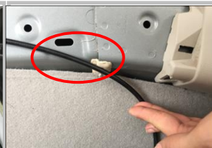
3.9 用扎带把圆圈位置的拉线固定好，防止拉线与盖板、钣金摩擦；
